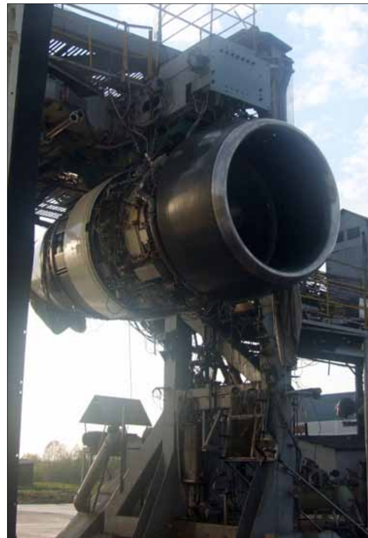
Подготовка воздухозаборника из композиционных материалов к акустическим испытаниям
