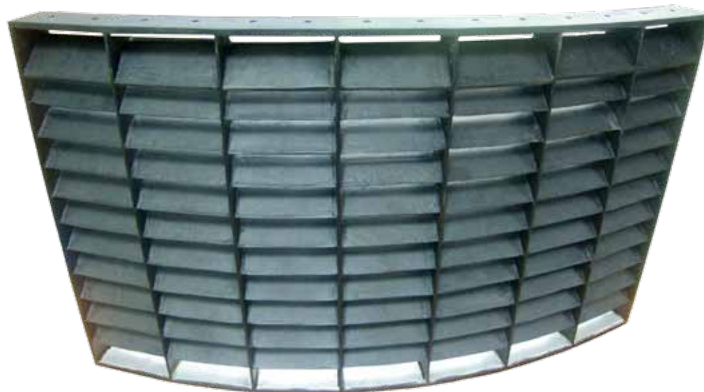
Решетка реверсивного устройства из углепластика
