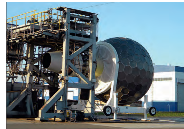
Двигатель ПС-90А2 во время акустических испытаний на открытом стенде ОАО «Авиадвигатель»
